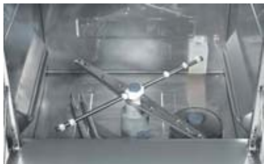
Particolare interno della vasca, camera di lavaggio completamente stampata
